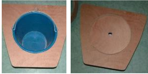
Figure 45 : Toilettes sèches intégrées
