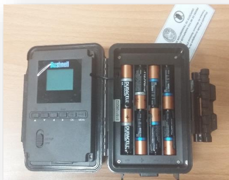
Figure 20: Piège photographique lors de sa pose, et vue de l'intérieur
